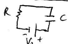
$$\text{TM MATERIA} \quad V_0 - Rq'(t) - \frac{1}{C} q(t) = 0$$
