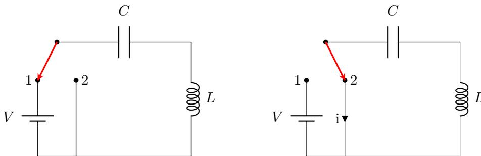
In un circuito LC è del tutto assente la componente resistiva. Caricato il condensatore con un generatore di corrente continua (o alternata, che viene disconnesso all'istante di picco di tensione dell'alternatore) ed escludendo il generatore con un commutatore, si osserva che la carica del condensatore inizia a diminuire, e scorre una corrente attraverso il circuito.
