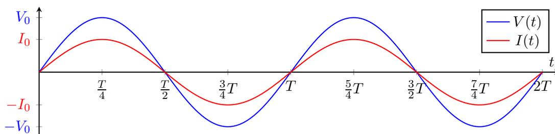
Trovo allora i valori medi della corrente e della tensione, per determinare la potenza media  $\overline{P}$ . Apparentemente  $\overline{I} = \overline{V} = 0$ , ma la potenza media non può essere zero!
